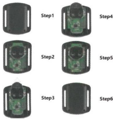
**Paso 1:** Utilice un destornillador de punta de 1,84 mm (no incluido) para quitar los 4 tornillos de la tapa trasera, lo que le permitirá abrirla.
